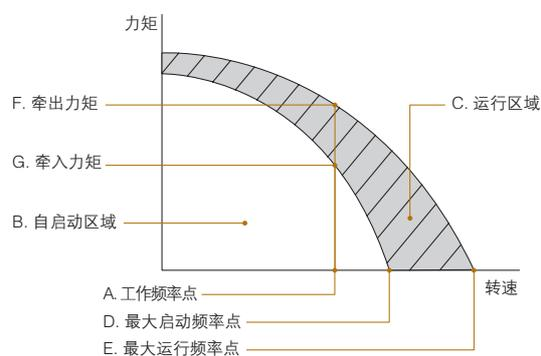
例如：步距角1.8°的步进电机，在1/2细分驱动方式下（即每步0.9°）、工作频率500Hz时的转速为1.25r/s。
