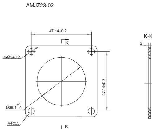
使用说明：降低电机与设备间因震动而产生的机械噪音。
